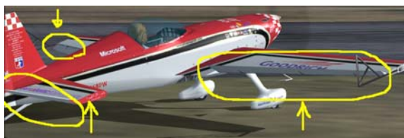
Figura 6. Uma aeronave com o profundor levantado, aileron direito para cima e esquerdo para baixo.
